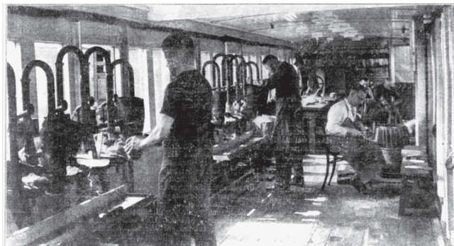
Abb. 2: Mobile Schuh-Reparaturwerkstatt der Wehrmacht in einem Eisenbahnwaggon (1942). Links Klebpressen für die Neubesohlung, rechts Boden- und Schaftreparaturen von Hand. Quelle: Handwerkerstube auf Rädern, Illustrierter Beobachter, Nr. 34, 1942.
