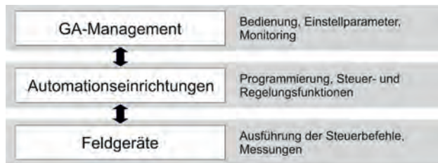
Bild 1: Ebenen der Automation in Gebäuden
