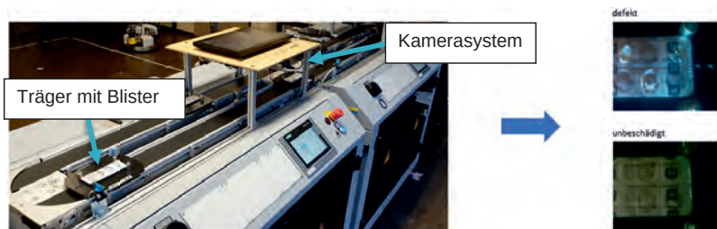
Bild 7: Versuchsaufbau Förderband für Blister-Transport und Beispielaufnahmen
