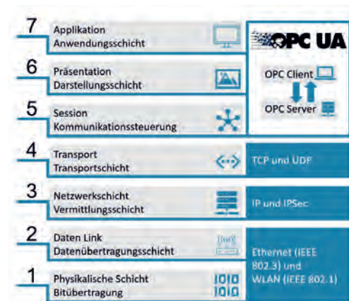
Bild 2: OPC UA gemappt auf ISO/OSI-7-Schichtenmodell [18]
