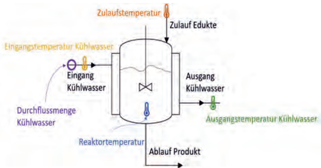
Bild 5: Schematischer Aufbau des Batchreaktors und den verwendeten Messungen.
