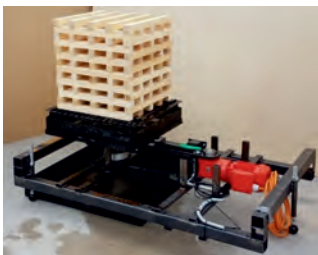
Bild 2: Aufbau des Prüfobjekts mit einer Vorrichtung zum Drehen während des Versuchs.
