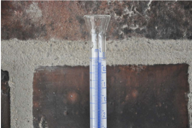
Abb. 8: Detail aus Abb. 7. Messstelle M1 nach der Fugensanierung. Nach 10 Minuten wurden 0,15 ml Wasser über die Fuge aufgenommen
