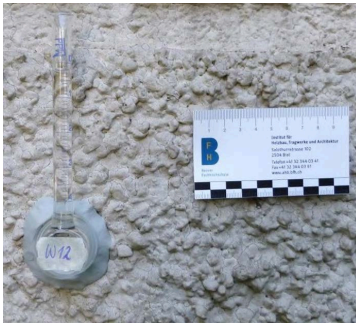
Bild 1: Karsten'sches Prüfröhrchen (links) und Franke'sche Prüfplatte (rechts), beide installiert auf einer historischen Putzfläche
