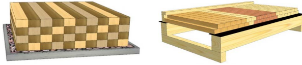
Bild 4: Links: Block-Test nach Pfeffer et al. (2008). Rechts: Horizontal-double-layer-Test nach Rapp und Augusta (2004).
