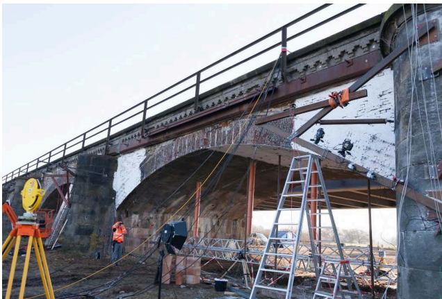
Bild 1: Belastungsversuch an der Mauerwerksgewölbebrücke über die Aller bei Verden, Bildquelle: Stephanie Franck
