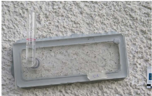
Bild 1: Karsten'sches Prüfröhrchen (links) und Franke'sche Prüfplatte (rechts), beide installiert auf einer historischen Putzfläche
