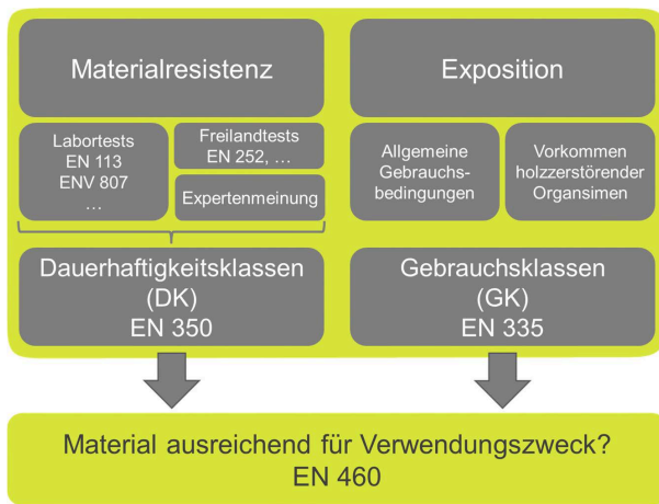
Bild 1: Verfahren zur Überprüfung, ob die natürliche Dauerhaftigkeit einer Holzart ausreichend für eine bestimmte Verwendung ist
