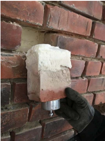
Bild 4: Haftzugversuch, Quelle: Giffey Saxler Architekten
