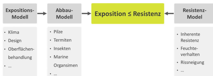
Bild 8: Performance-basiertes Designkonzept. Eine ausgewählte Kombination aus Material und Design wird als geeignet betrachtet wenn die Expositions-Dosis [hier: Exposition] gleich oder geringer als die kritische Dosis, resultierend aus der Resistenz des Materials [hier: Resistenz], ist
