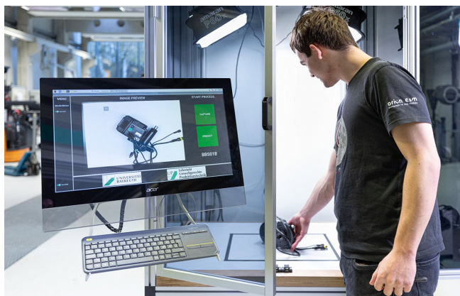
Bild 4. Demonstrator zur KI-gestützten Variantenklassifikation im RemanLab. Foto: Fraunhofer IPA
