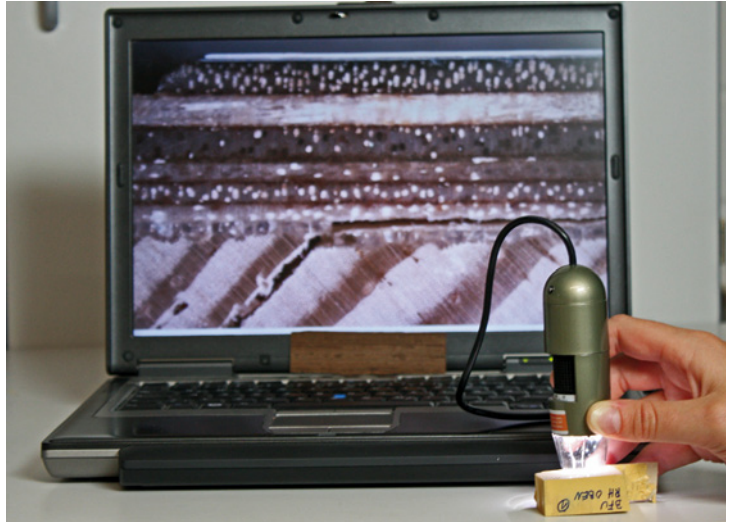
Bild 5.74 Einsatz eines USB-Mikroskops beim Ortstermin und im Labor
