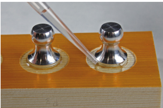
Bild 5.56 Prüfung der Nasshaftung durch Bestimmung der Abreißfestigkeit; um aufgeklebte Stempel sind Nuten eingefräst. In die Nuten wird Wasser geträufelt. Nach einer definierten Einwirkzeit werden die Stempel hydraulisch abgezogen und die dazu notwendige Kraft wird bestimmt.
