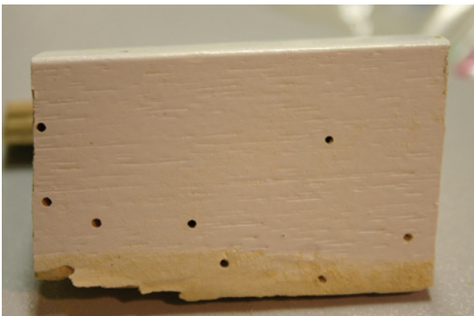
Bild 5.32 Stück einer Türzarge mit Ausflughöchern von Splintholzkäfern. Es war zu prüfen, ob das Holz schon beim Einbau befallen war. Nach dem Abschleifen der Lackierung erkennt man im unteren Bereich des Holzes unterschiedlich geformte Fraßgänge. Solche Formen können nur vorkommen, wenn bereits vorhandene Gänge angeschnitten wurden. Damit ist gesichert, dass Larven des Käfers schon während der Bearbeitung vorhanden waren.
