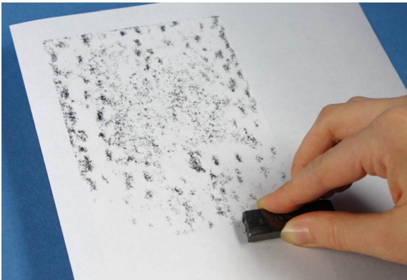
Bild 5.13 Mit einem Grafitblock wird über ein auf die Probe gelegtes Papier gerieben. Die Frottage dokumentiert die Oberflächenstruktur der Probe.
