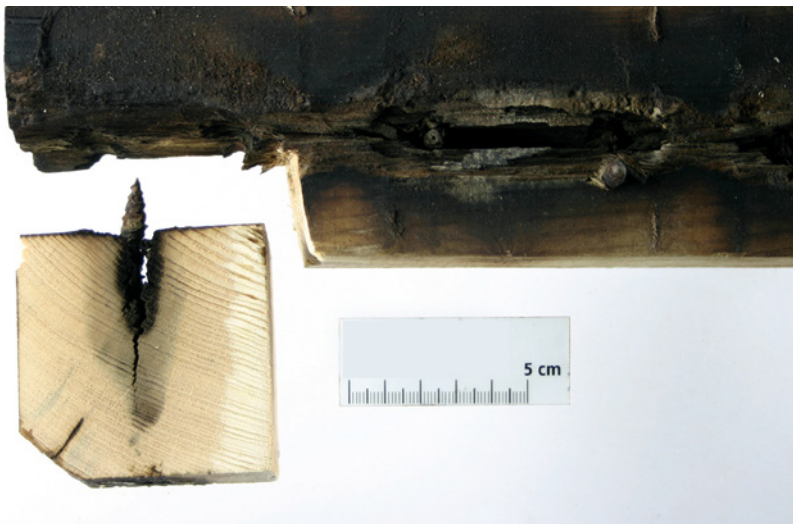
Bild 4.37 Rostende Schrauben können im Sitzbankbereich von Saunakabinen das Holz stark schädigen. An dieser Stelle kommen Temperatur, Feuchtigkeit und korrosives Chlorid durch den Schweiß zusammen.
