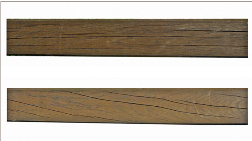
Bild 4.1 Die Trocknungsrisse der beiden Eichenpfosten folgen dem Faserverlauf. Der Verlauf der Fladerung ist kein Indikator für die Faser- richtung/Rissrichtung.
