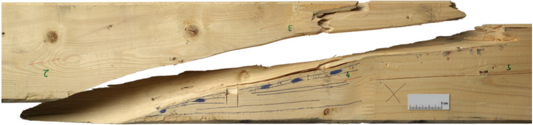
Bild 4.5 Bruch eines Trägers aufgrund von unzulässiger Schrägfaserigkeit von 18 % bis 25 % ( 10^\circ bis 15^\circ ). Vor dem Bruch waren keine Trocknungsrisse vorhanden, die den Faserverlauf angezeigt hätten. Die Festigkeiten, besonders bei dynamischer Belastung, können durch eine solche Schrägfaserigkeit erheblich reduziert sein. Gemäß DIN 4074-1:2008 [19] sind für die Sortierklasse S10 Faserabweichungen von 12 % ( 6,8^\circ ) zulässig.
