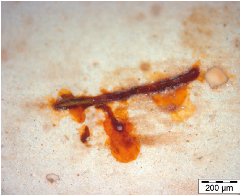
Bild 4.36 Die Form dieses Eisen/Rost-Partikels legt nahe, dass es sich um Reste von Stahlwolle handelt.
