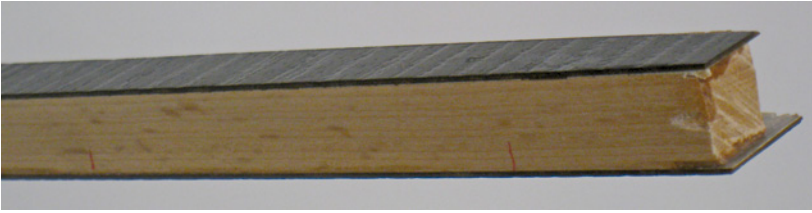
Bild 5.83 Um den Querschnitt dieses Schichtstoffes zu schleifen, wurde er beidseitig auf eine Holzleiste 10 mm × 10 mm geklebt.
