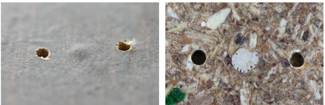
Bild 5.21 Durch zwei Bohrungen im Durchmesser von 1 mm wurde die Position einer lokalen Aufwölbung auf einer beschichteten Spanplatte markiert. Nach dem Abschleifen der Beschichtung erkennt man zwischen den Bohrungen einen weißen Kunststoffpartikel.
