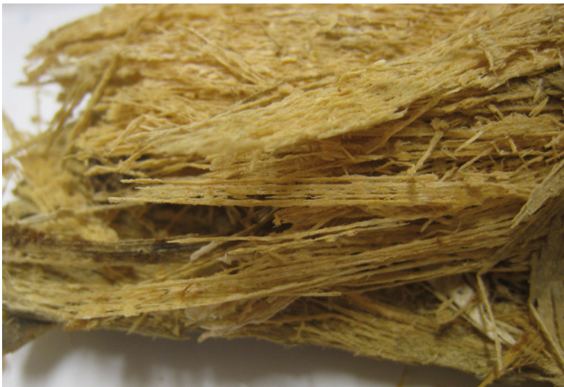
Bild 3.32 Durch einen Weißfäulepilz mazeriertes Holz
