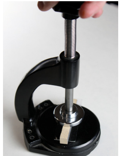
Bild 5.85 Querschliffe werden auf einer geeigneten Masse auf einem Objektträger fixiert. Mit einer Schliffpresse wird die geschliffene Fläche exakt parallel zu dem Objektträger ausgerichtet.
