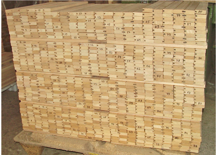
Bild 5.2 Probenahme aus einem Paket Buchenleisten zur Feststellung der Fräsqualität. Die schwarzen Ziffern an den Hirnenden markieren die Proben, welche zur Bemusterung vorgesehen waren.
