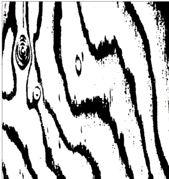
Bild 5.19 Zur Bildanalyse wird das Bild anhand genauer Vorgaben zur Bewertung der einzelnen Farbkanäle in ein Schwarz-Weiß Bild umgewandelt. Laut der Analyse besteht die Oberfläche zu 31,5 % aus Spätholz. Bei einigen Strukturen, die laut Bildanalyse Spätholz sind, kann dies aus holzanatomischer Sicht ausgeschlossen werden. Die Genauigkeit des Zahlenwerts darf nicht darüber hinweg täuschen, dass es sich letztlich um eine Schätzung handelt.
