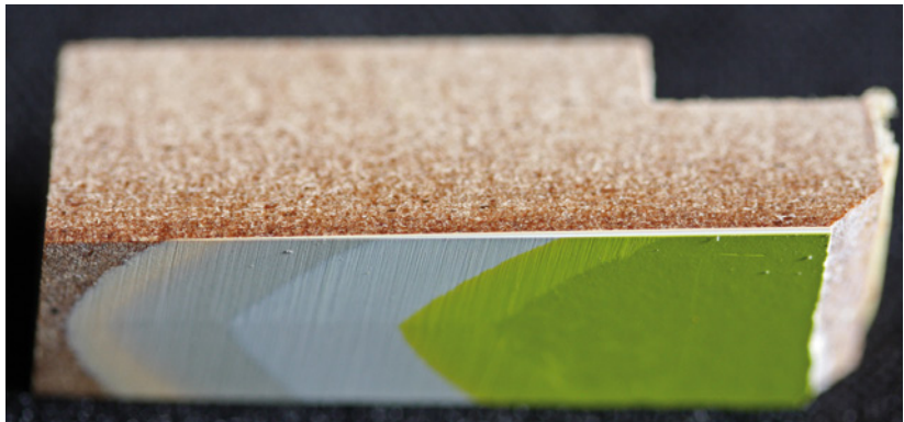
Bild 5.26 Keilschliff im Winkel von 1^\circ einer 800\text{ }\mu\text{m} ( 0,8\text{ mm} ) dicken Lackierung aus vier Schichten. Die Schichtenfolge ist auf dem Keilschliff auf einer Länge von 23\text{ mm} ausgebreitet und damit weitergehenden Analysen zugänglich. Bei dem manuellen Schleifen werden die Schleife zwar zu den Kanten hin meist etwas intensiver, das Dickenverhältnis der Beschichtungen bleibt jedoch überall erhalten.
