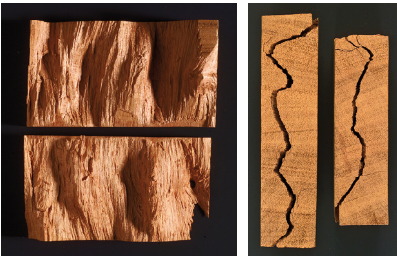
Bild 3.17 Risse in Arbeitsplatten aus Buche. Links ein wahrscheinlich durch äußere Kräfte verursachter Riss quer zu den Holzstrahlen (tangential), rechts ein in Holzstrahlrichtung (radial) verlaufender typischer Schwindriss.
