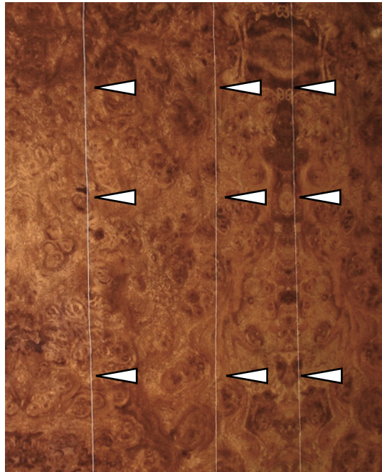
Bild 4.41 Riss in HPL, ausgehend von einem rechtwinkligen Ausschnitt ohne Rundung (links). Im gleichen Objekt traten aufgrund längerer extrem niedriger relativer Luftfeuchte von unter 20 % auch Längsrisse im HPL auf (rechts). Wären nur von den Ecken der Ausschnitte ausgehende Risse vorhanden, wäre unabhängig von der vermuteten relativen Luftfeuchte die fehlende Rundung der Ecke als maßgebliche Schadensursache anzunehmen. Erst die auch vorkommenden Längsrisse zeigen, dass offensichtlich eine andere wesentliche Ursache – nämlich die extreme Untertrocknung, anzunehmen ist (siehe auch Kapitel 4.7.1)
