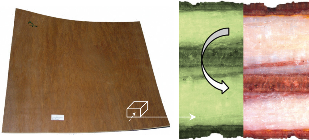
Bild 3.34 Ein nicht symmetrischer Sperrholzaufbau hat zu starken Verformungen geführt. Zur Veranschaulichung der Asymmetrie wurde ein Teil des Querschnitts der fünfplagigen Sperrholzplatte verdoppelt und gespiegelt. Bei einem symmetrischen Aufbau lägen die Schichten des Originals und des gespiegelten Bildes in der gleichen Ebene.
