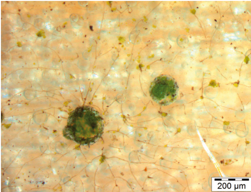
Bild 4.27 In den zur Oberfläche hin geöffneten Mikroschaumbblasen einer transparenten Beschichtung haben sich Algen und Pilze angesiedelt.
