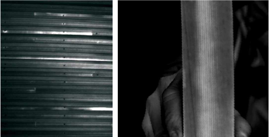
Bild 5.70 Thermografische Abbildung einer Wandfläche aus furnierten Stäben. Auf mehreren hundert Quadratmetern Wand- und Deckenflächen hatte sich an manchen Stellen das Furnier von den Stäben gelöst. Vor Ort wurden Wände mit einem vorbeigeführten Heizstrahler kurz erwärmt. In der thermographischen Aufnahme zeigen helle Flächen Zonen ohne Haftung zum Untergrund. Derartige Zonen kamen auch an vielen Stellen vor, die bei visueller Betrachtung nicht erkannt worden waren. Das thermographische Detailbild rechts zeigt die Schadensursache: Unverpresste Klebstoffraupen in der Mitte des Stabes.
