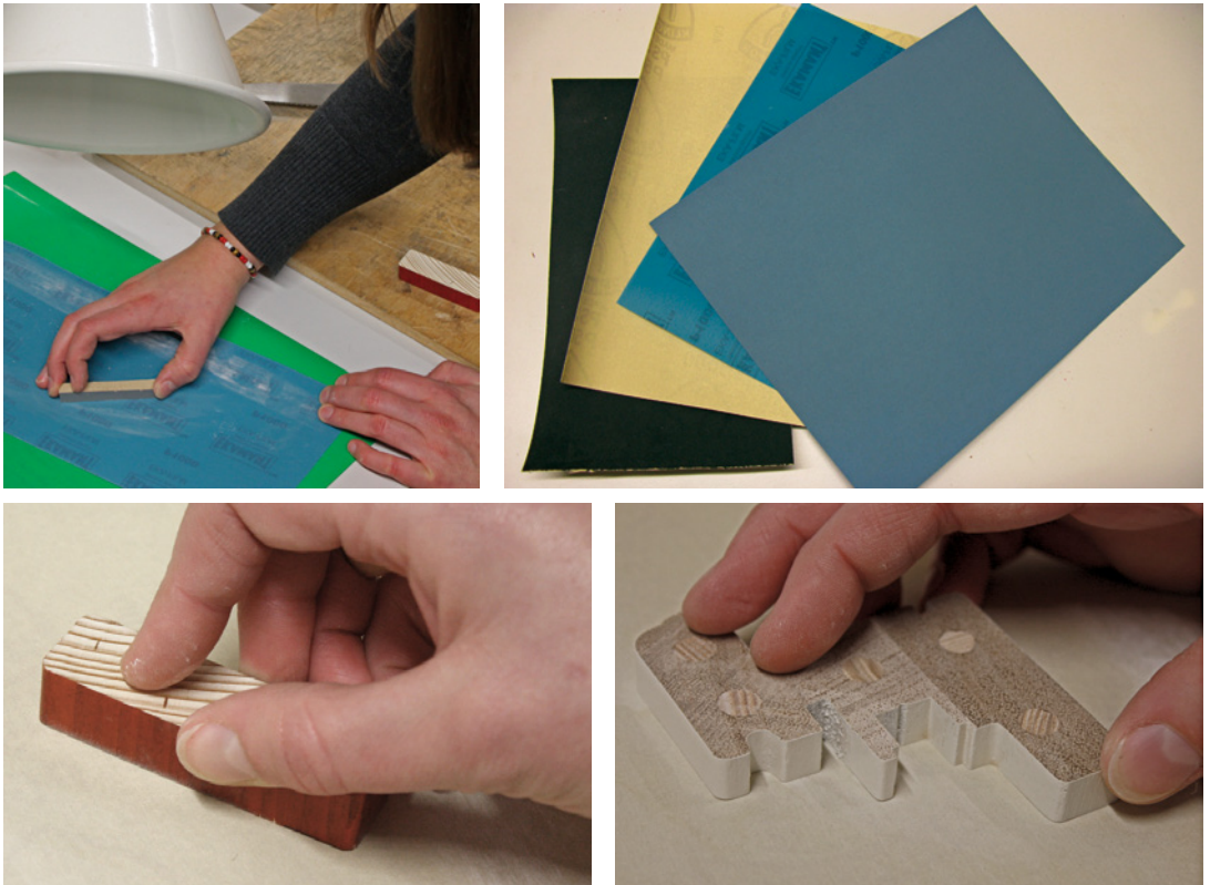
Bild 5.81 Schleifen von Hand; verwendet werden z.B. Papiere der Körnungen P 220, P 500, P 1 000 und P 3 000. Geschliffen wird bevorzugt in Längsrichtung der Probe, weil damit die Gefahr des Verkantens am geringsten ist. Um die Schleifspuren der vorangegangenen Körnung zu beseitigen kann aber auch quer oder kreisförmig geschliffen werden. Auf die Probe wird nur ein geringer Druck ausgeübt. Die Unterlage muss absolut plan sein – Übung macht den Meister.
