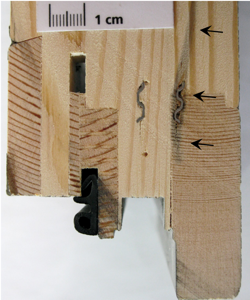
Bild 5.53 Von einem Wellennagel in einer Fenster-Eckverbindung gehen Verfärbungen aus. In erster Näherung kann davon ausgegangen werden, dass ein derartiger Transport von Eisensalzen mehrere Tage bis Wochen bei Holzfeuchten von über 30 % voraussetzt [74].
