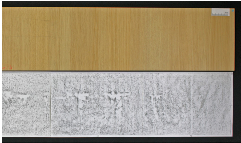
Bild 5.14 Die fotografisch fast nicht dokumentierbaren ca. 20 µm tiefen Strukturen auf einem Schichtpressstoff wurden durch einen über aufgelegte Papiere geriebenen Grafitblock großflächig dokumentiert. Einige der so erkannten Oberflächenstrukturen waren selbst bei intensiver Inspektion im Schräglicht zuvor nicht aufgefallen.
