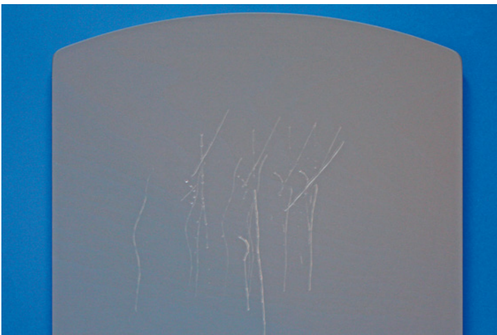
Bild 4.30 Riefen auf den Sitzflächen von Schulmöbeln werden häufig durch Nieten an den Hosen verursacht. Sie fallen jedoch üblicherweise wenig auf. Durch ihren Weißbruch kontrastieren die hier abgebildeten Riefen auffällig mit dem grauen Untergrund.
