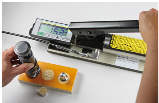
Bild 5.56 Prüfung der Nasshaftung durch Bestimmung der Abreißfestigkeit; um aufgeklebte Stempel sind Nuten eingefräst. In die Nuten wird Wasser geträufelt. Nach einer definierten Einwirkzeit werden die Stempel hydraulisch abgezogen und die dazu notwendige Kraft wird bestimmt.
