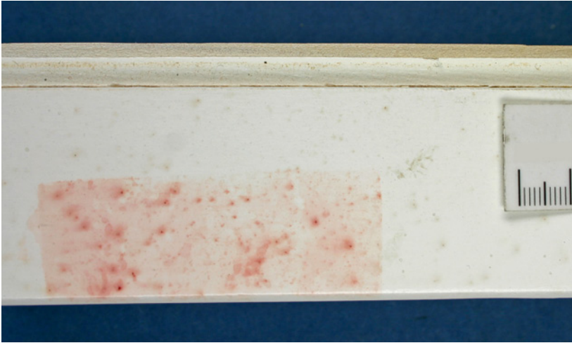
Bild 5.119 Graue Verfärbungen auf der Lackoberfläche eines Fensters. Auf einen Abschnitt eines saugfähigen Papiers wurde Kaliumthiocyanat-Lösung geträufelt und auf das Fenster gelegt. Die rote Färbung zeigt Eisen als Ursache der Verfärbung.
