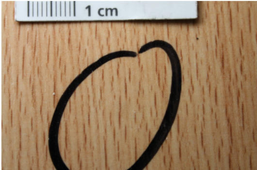
Bild 5.6 Die Erhebung auf einer Schichtstoffoberfläche wird nur bei schräger Beleuchtung dokumentierbar.
