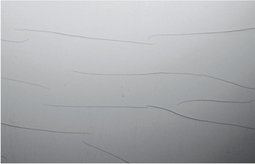
Bild 3.11 Obwohl die Risse eine Vorzugsrichtung zeigen, ist anhand des bogenförmigen Rissverlaufs und der zum Teil deutlich gebogenen Rissenden von durch den Lack verursachten Rissen auszugehen.
