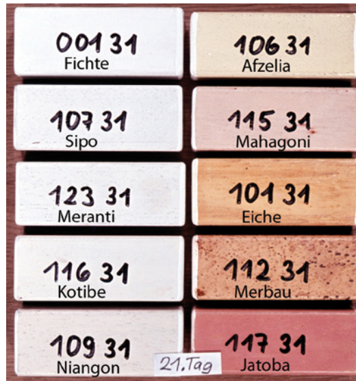
Bild 4.8 Nach 21 Tagen Lagerung im Feuchtklima ist die weiße Beschichtung durch durchgeschlagene Inhaltsstoffe verschiedener Holzarten zum Teil erheblich verfärbt. (Quelle: [5] Peter Böttcher)
