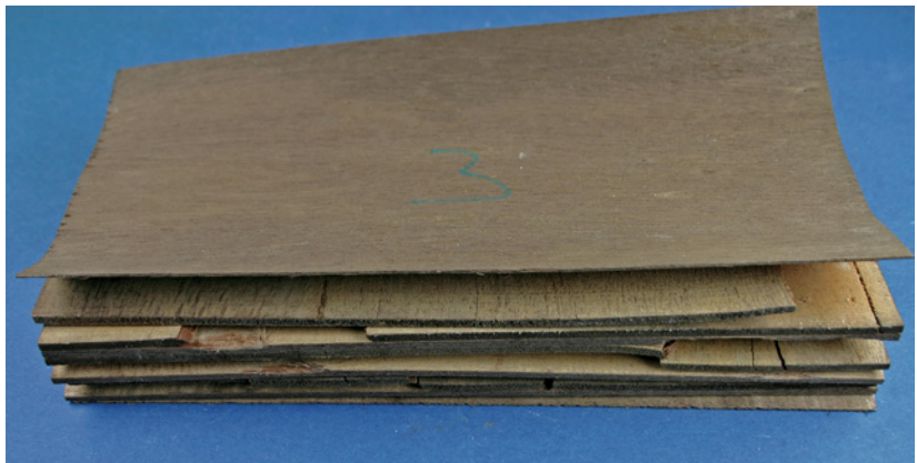
Bild 5.54 Sperrholz, das nach 6stündigem Kochen auseinanderfällt, bedarf keiner weiteren Prüfungen, um eine normgemäße Wasserbeständigkeit auszuschießen.
