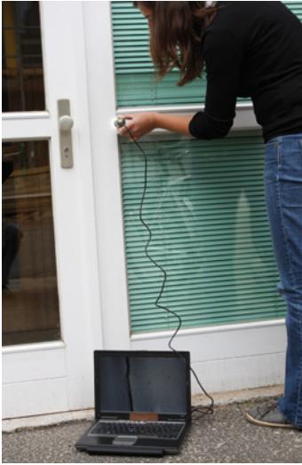
Bild 5.74 Einsatz eines USB-Mikroskops beim Ortstermin und im Labor
