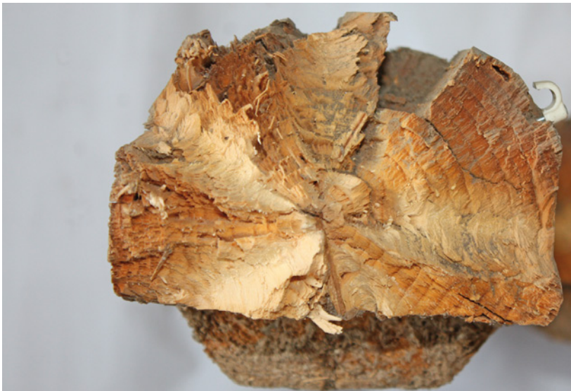
Bild 5.30 Die Verfärbung auf Teilen der Bruchfläche eines Kantholzes zeigt, dass hier schon vor dem Bruch quer zur Faserrichtung verlaufende Risse vorhanden waren.
