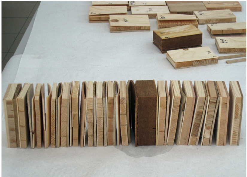
Bild 2.2 Für die Verklebung mehrschichtiger Parkette gibt es keine Anforderungen. Eine vergleichende Prüfung (hier mit 17 handelsüblichen Parketten) ermöglicht eine Einordnung der Qualität eines strittigen Produkts.
