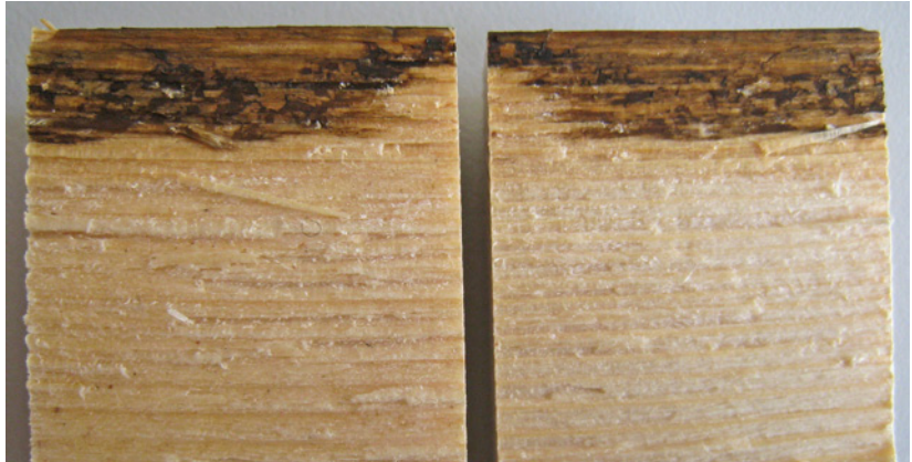
Bild 5.31 Die in die Bruchzone eingedrungene Lasur zeigt, dass ein Riss bereits vor der letzten Lasurbehandlung vorhanden war.
