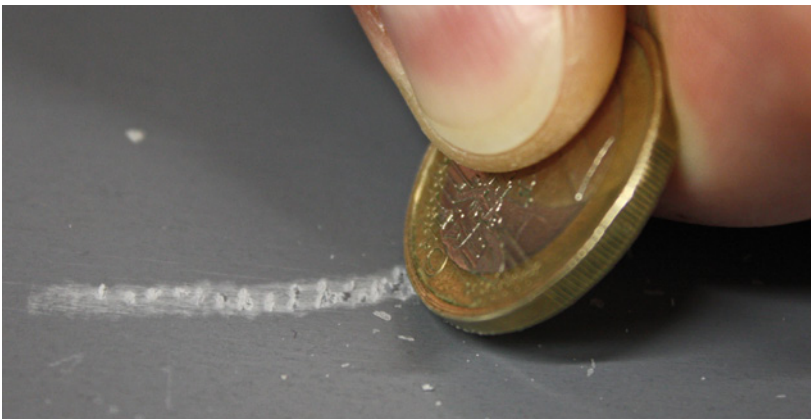
Bild 5.57 Eine Münze wird mit festem Druck über die Lackoberfläche gezogen. Die weiße Färbung der Druckspur (Weißbruch) zeigt, dass es sich um einen sehr spröden Lack handelt.
