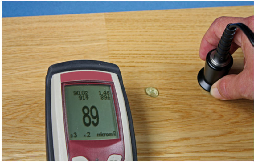
Bild 5.105 Messung der Schichtdicke mit Ultraschall. Zunächst wird ein Gel aufgetragen, auf das dann der Messkopf gedrückt wird.
