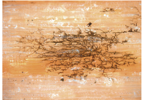
Bild 5.120 Links: Eisenpartikel auf Douglasienholz. Das rote Quadrat zeigt den positiven Nachweis auf Eisen mit Kaliumthiocyanat. Rechts: Als schwarzer Punkt auf Lärchenholz erscheinender Befall durch Oberflächenpilze bei mikroskopischer Betrachtung. Mit bloßem Auge sind Oberflächenpilze meist nicht sicher von Eisenpartikeln unterscheidbar. Bereits mit einer Lupe ist in der Regel jedoch eine sichere Diagnose möglich.
