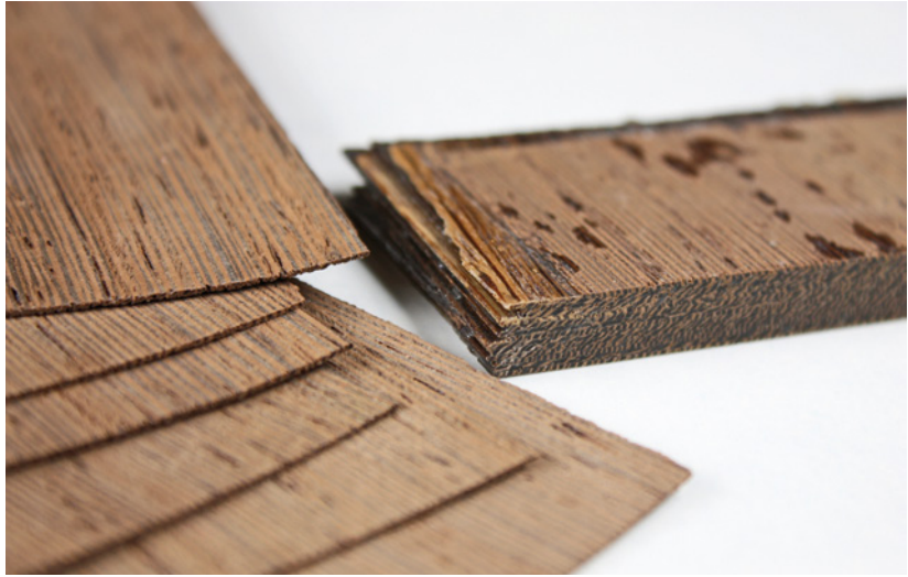
Bild 5.86 Mehrere Furniere werden zu einem Block verklebt und können so geschliffen werden.
