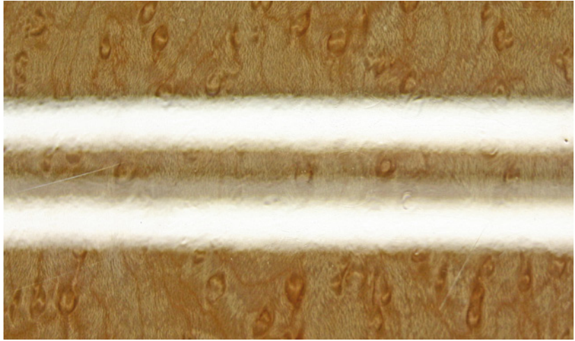
Bild 5.5 Im Grenzbereich der Reflektion von Leuchtstoffröhren lassen sich selbst minimale Erhöhungen von wenigen tausendstel Millimetern ( \mu\text{m} ) auf glänzenden Oberflächen erkennen und dokumentieren.
