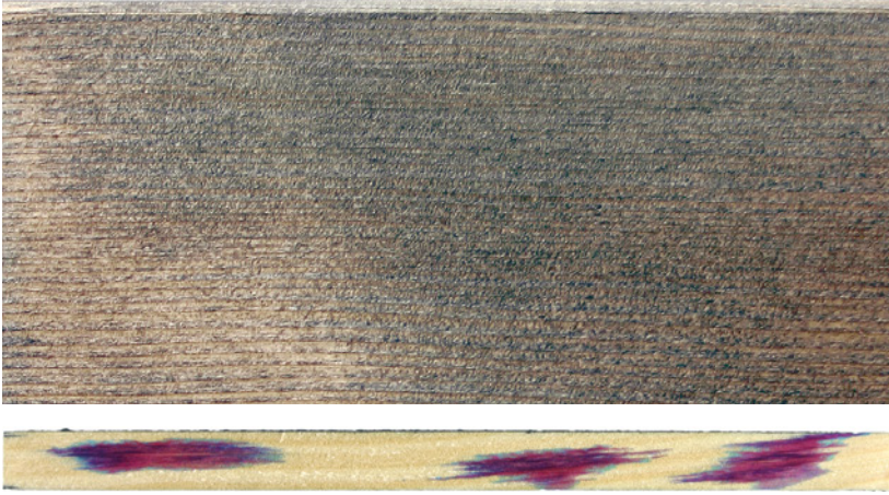
Bild 4.3 Unregelmäßiges Eindringen einer Lasur in Fichtenholz aufgrund von Schrägfaserigkeit. Auf dem Längsschnitt wurde die Faserrichtung durch aufgetropfte Tinte sichtbar gemacht.
