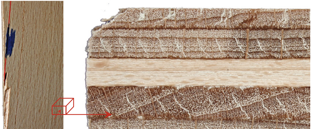
Bild 4.4 Faserabweichungen in der Deckschicht von Sperrholzleisten führen im Zusammenspiel mit tiefen Schälrisen und Druckholz zu Absplitterungen an den Kanten.
