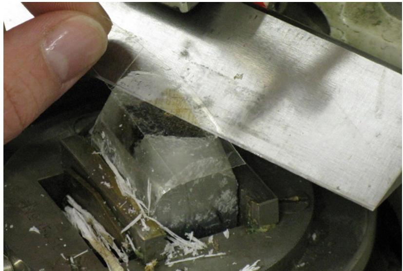
Bild 5.93 Schneiden einer in PEG eingebetteten Probe mit der Klebefilmmethode
