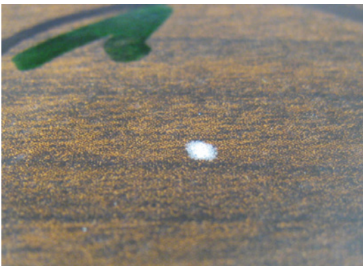
Bild 4.16 Ein weißer Fleck auf dem Melaminpapier einer Spanplatte. Im Querschliff erkennt man, dass ein Loch in der Deckschicht der Spanplatte zu der Verfärbung geführt hat: Da der Gegendruck fehlte, entstanden an dieser Stelle Luftblasen im Melaminfilm, die aufgrund der Lichtstreuung weiß erscheinen.
