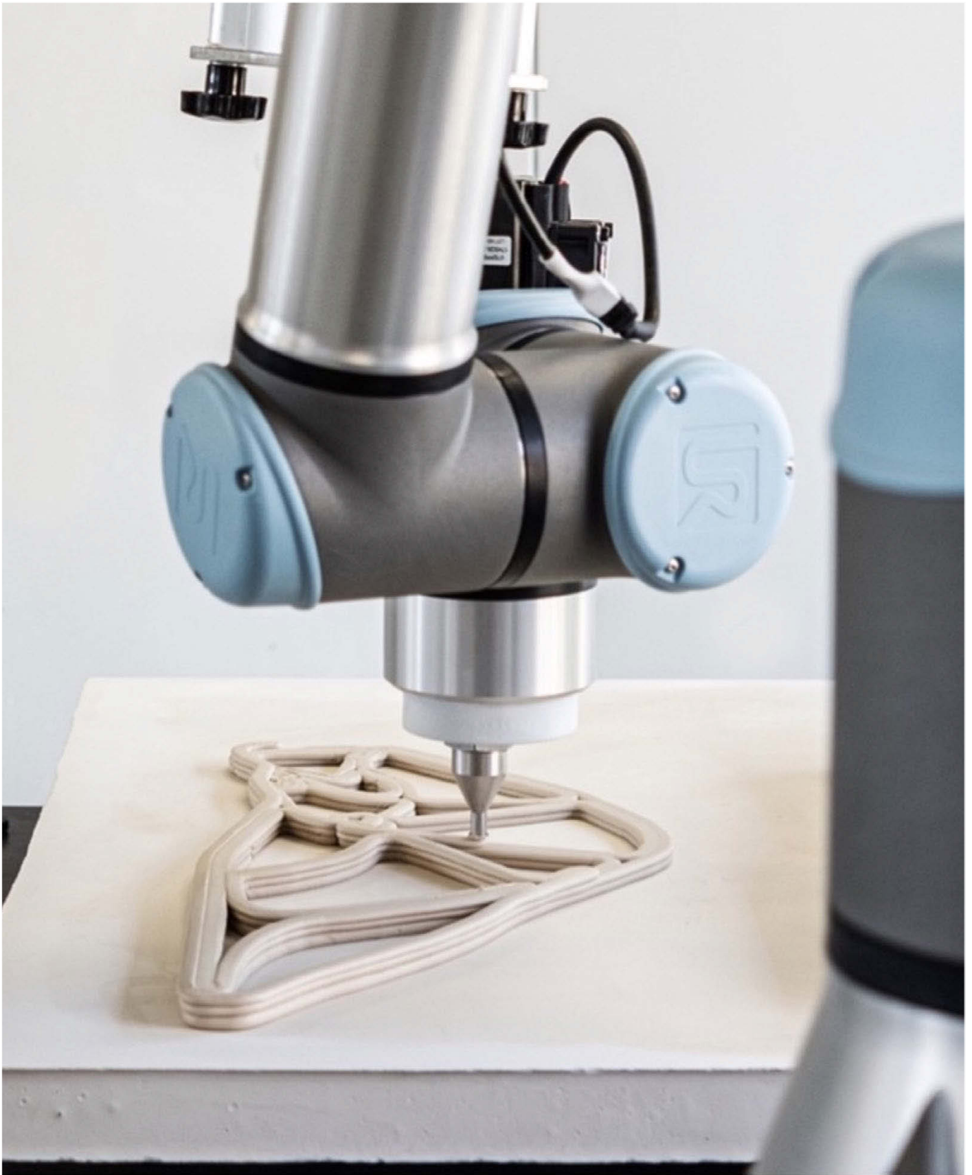
Abb. 2: Robotergetstützte additive Fertigung von nicht standardisierten Porzellanstrukturen.
