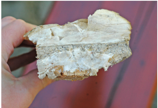
Bild 49 ■ Weißes, cremeartiges Oberflächenmyzel des Ausgebreiteten Hausporlings (an Schaumstoff erinnernd)
