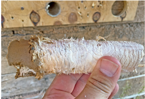
Bild 119 ■ Entnommener Bohrkern mit feuchtem Erdbreich an der Rückseite
