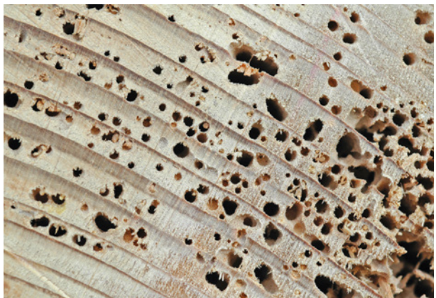
Bild 74 ■ Querschnitt mit Fraßgängen des Gewöhn- lichen Nagekäfers, die im Frühholz der Jahrringe verlaufen
