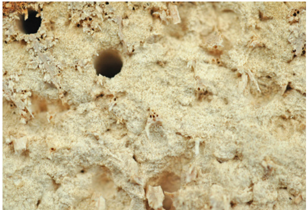
Bild 76 ■ Fraßbild des Braunen Splintholzkäfers: Im fortgeschrittenen Befallsstadium ist das Holz zerpulvert.
