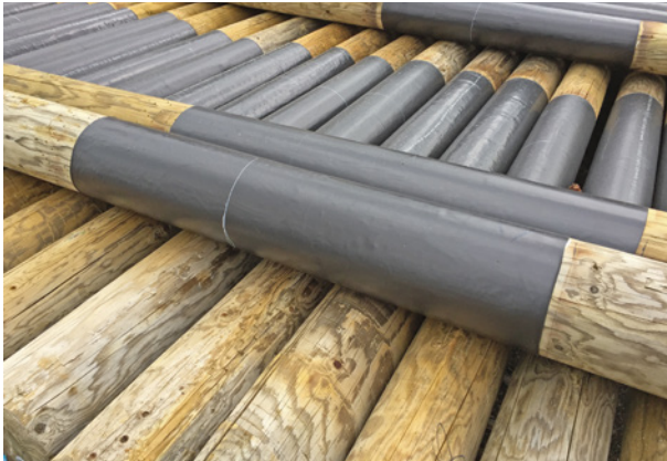
Bild 100 ■ Mit Holzschutzmittel behandelte Leitungsmasten aus Holz und zusätzlichem Schutz (Fürstenberg-Permadur®-System) im Bereich der sensiblen Erd-Luft-Zone
