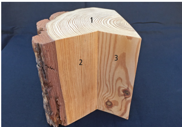
Bild 13 ■ Hauptschnitte des Holzes: 1 Querschnitt 2 Radialschnitt 3 Tangentialschnitt
