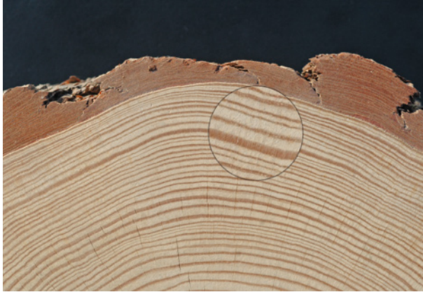
Bild 10 ■ Jahrringe und Jahrringgrenzen am Hirnholz einer Kiefer. Das Spätholz ist dunkel, das Frühholz hell.
