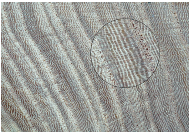
Bild 11 ■ Weitlumige Frühholzgefäße (Poren) am Hirnschnitt von einer Eiche. Die Frühholzgefäße sind zu einem Ring angeordnet und bilden einen deutlichen Übergang zum anschließenden Spätholz.
