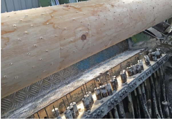
Bild 115 ■ Herstellung der Perforierung, in geringen Abständen werden kleine Löcher in das Holz gebohrt
