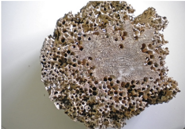
Bild 91 ■ Hirschnitt an einer Buhne mit starkem Schiffsbohrmuschelbefall: Es liegt Bohrgang an Bohrgang.
