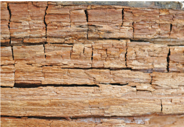
Bild 24 ■ Braunfäule: typischer Würfelbruch von wenigen Millimetern bis mehreren Zentimetern und braun verfärbtes Holz durch das Zurückbleiben von braunem Lignin
