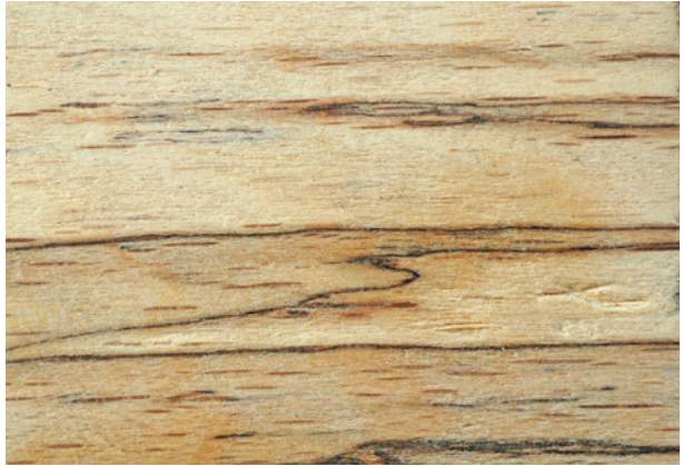
Bild 25 ■ Weißfäule: hell bis weiß verfärbtes Holz mit dunkelgefärbten Grenzlinien
