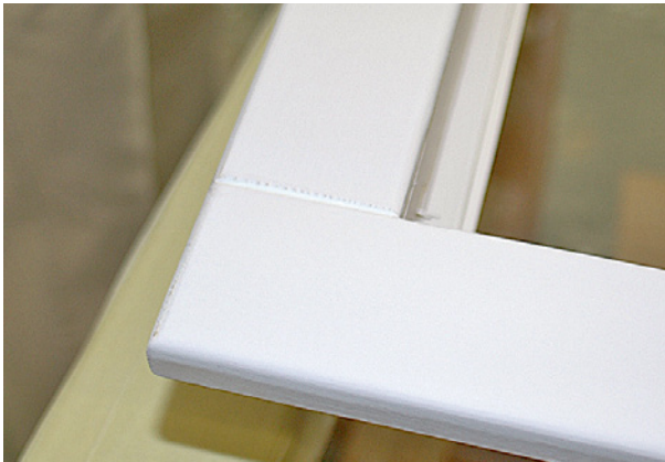
Bild 160 ■ Mit Fugensiegel verschlossene Eckverbindung im Rahmen der Fensterherstellung
