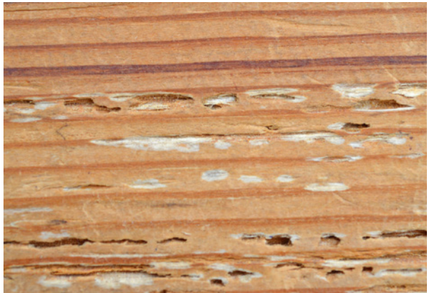
Bild 26 ■ Weißblochfäule: Längliche Löcher im Holz sind mit Celluloseresten ausgefüllt.
