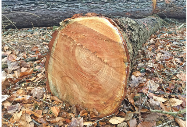
Bild 4 ■ Hirnschnitt von Kiefer als Fällschnitt mit deutlich rötlichem Farbkern
