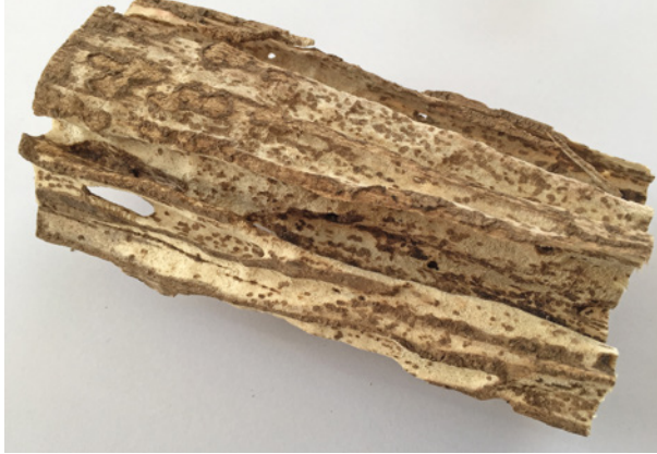
Bild 90 ■ Von Termiten der australischen Art Mastotermes darwiniensis ausgehöhltes und zerstörtes Holz
