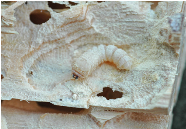
Bild 68 ■ Die Larve des Hausbockkäfers ist elfenbeinfarben und wird bis zu 3 cm groß.
