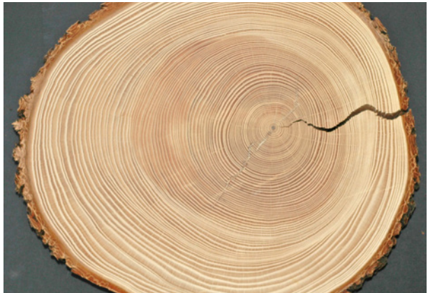
Bild 5 ■ Hirnschnitt von Douglasie (geschliffen) mit rötlichem Farbkern
