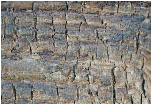
Bild 27 ■ Moderfäule: Dunkle Holzoberfläche – nach Austrocknung entsteht ein sehr feiner Würfelbruch im Millimeterbereich.
