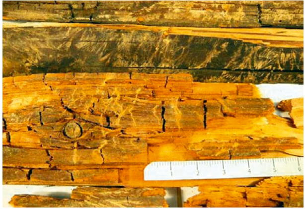
Bild 37 ■ Fäulebild des Braunen Kellerschwamms: Würfelbruchlänge von 1 bis 2 cm (Foto: Björn Weiß, Dresden)
