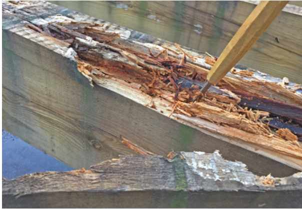
Bild 187 ■ Mit Pilzmyzel durchwachsesenes braunfaules Holz
