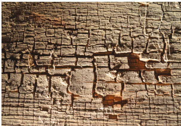
Bild 42 ■ Fäulebild des Weißen Porenschwamms mit kleinerem Würfelbruch
