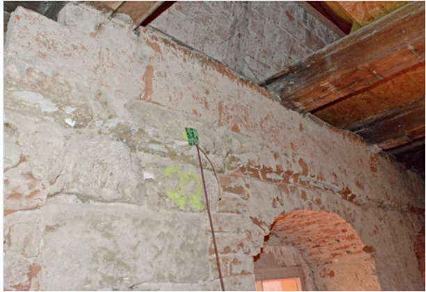
Bild 197 ■ Temperaturmesspunkt in der zu behandelnden Wandfläche mit integrierter Myzelprobe für die Erfolgskontrolle
