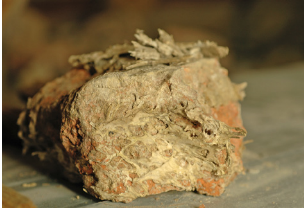
Bild 195 ■ Von Pilzmyzel überwuchertes Mauerwerk
