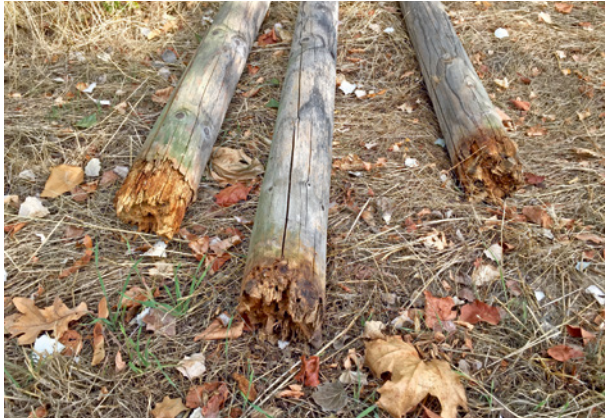
Bild 112 ■ Zerstörte Holzpfähle nach kurzer Standzeit von drei Jahren
