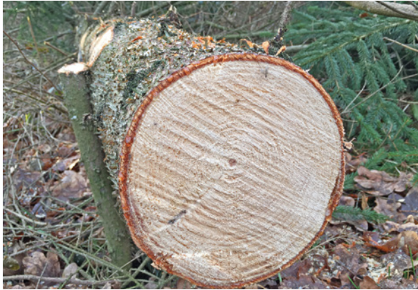
Bild 6 ■ Reifholz von Fichte ohne visuelle Unterscheidbarkeit zwischen Kern- und Splintholz
