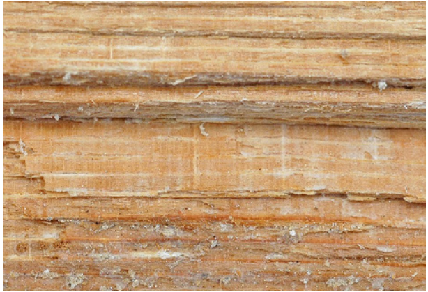
Bild 48 ■ Typische Weißfäule als Fäulebild des Ausgebreiteten Hausporlings
