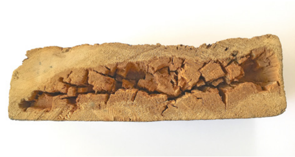
Bild 51 ■ Von den Blättlingen häufig erzeugte kritische Innenfäule als Braunfäule. Die Außen-seite der Holzbohle erscheint visuell noch intakt.
