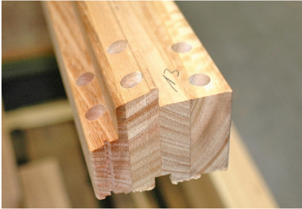
Bild 159 ■ Eckverbindung als Dübelverbindung (Holzart Eukalyptus)
