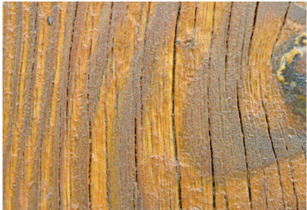
Bild 172 ■ Das härtere Spätholz bleibt etwas erhaben gegenüber dem Frühholz stehen.
